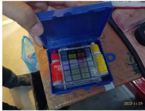
เครื่องมือที่ใช้ตรวจวิเคราะห์ปริมาณคลอรีน/ความเป็นกรด-ด่าง
